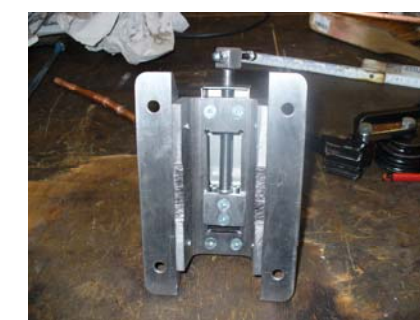
Hier: Projekt „Schraubstock“ (Gewindeschneiden, reiben, senken, meißeln etc.)
